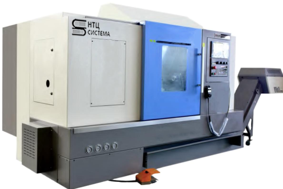
Высокоскоростной токарный обрабатывающий центр LM650 имеет полностью литую жесткую станину, выполненную из высокопрочного чугуна с углом наклона 30°. Станок оснащен ШВП и рельсовыми направляющими качения прецизионного класса точности. Станок LM650 является надежным оборудованием для обработки любых заготовок малых и средних размеров, нарезания всех видов резьб, любой внешней и внутренней обработки тел вращения.
